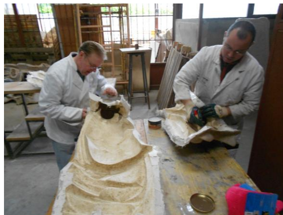
Tratamiento del molde semi-flexible para positivar en resina de poliéster.
