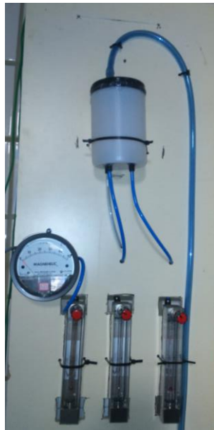
Figura AI.9 Instalación de los rotámetros en el laboratorio
