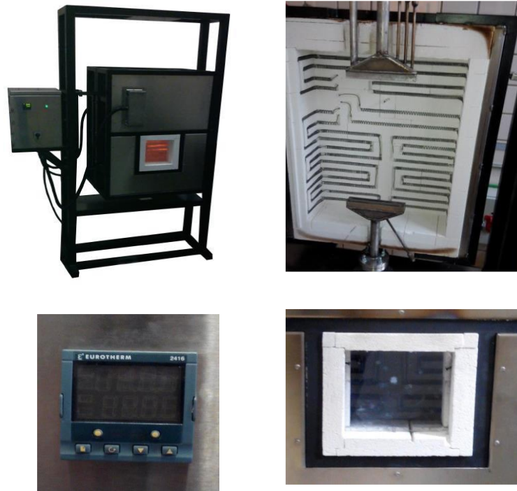
Figura A1.1 Horno eléctrico de la instalación del laboratorio
