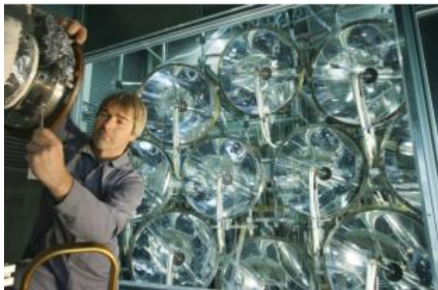
Figura 19. Lámparas de xenón horno solar PSI [18]
