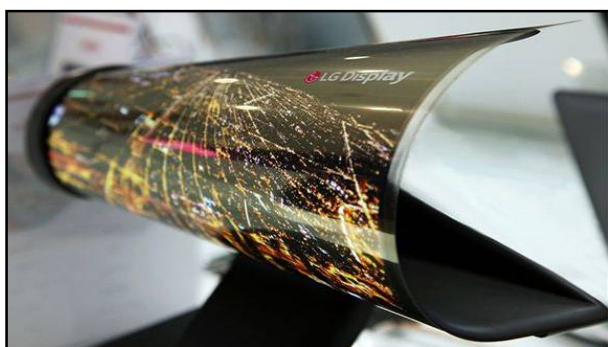
Figura 7. Fotografía de una pantalla OLED flexible diseñada por la compañía LG. ( www.computerhoy.com )
