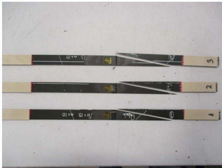
Figura 55: Probetas Off-Axis Tipología 3 tras ser ensayadas
