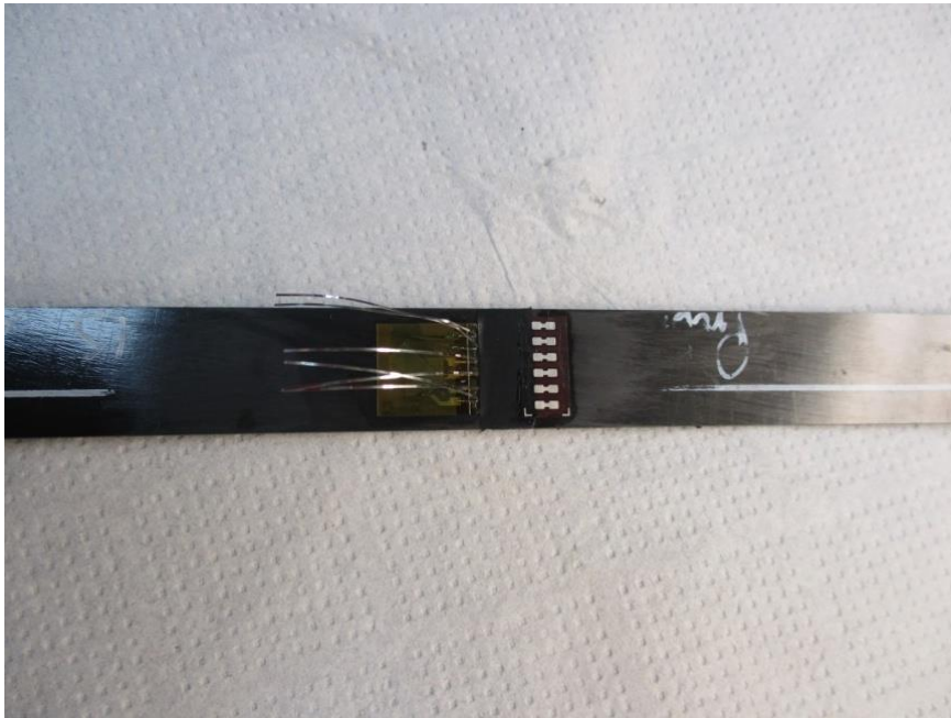
Figura 37: Colocación de cinta aislante y tira de contactos
