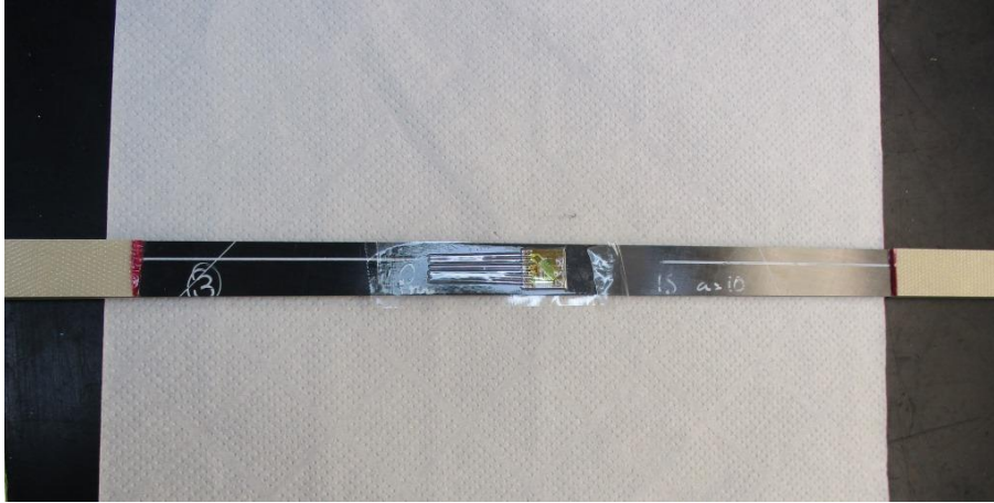
Figura 32: Colocación de la banda ayudado de la cinta adhesiva
