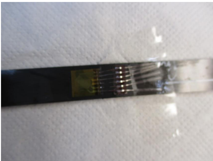
Figura 38: Realización de la soldadura
