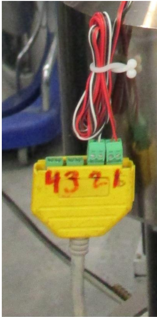
Figura 36: Conector intermedio para facilitar el conexionado con el D-sub 25
