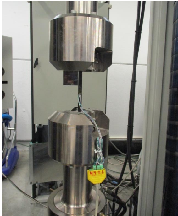
Figura 49: Configuración de ensayo probetas Off-Axis
