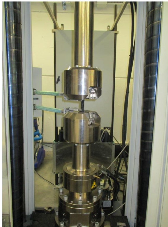
Figura 45: Configuración ensayo de tracción 90°
