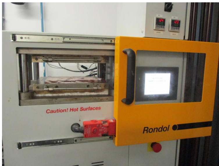
Figura 30: Prensa de platos calientes
