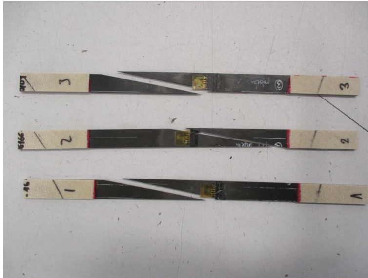
Figura 51: Probetas Off-Axis Tipología 1 tras ser ensayadas
