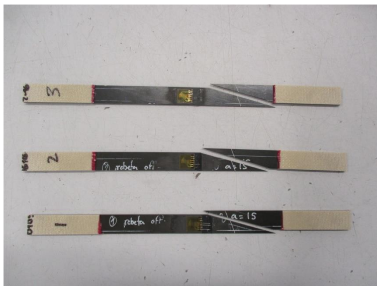
Figura 53: Probetas Off-Axis Tipología 2 tras ser ensayadas
