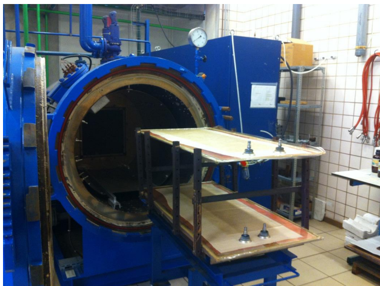
Figura 24: Estructura metálica y autoclave
