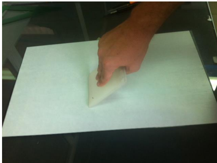
Figura 22: Compactación de las láminas de pre-preg
