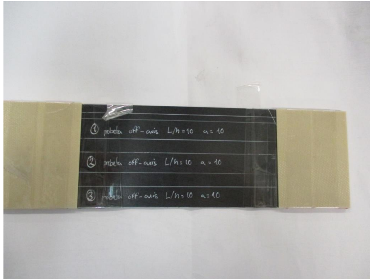
Figura 29: Colocación de la cinta adhesiva
