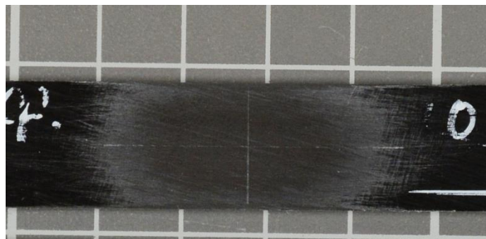
Figura 31: Probeta tras haber sido lijada y marcado su centro
