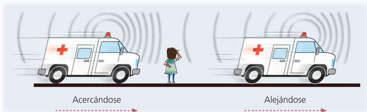
Figura 2-1: Observación del efecto Doppler en la sirena de una ambulancia
