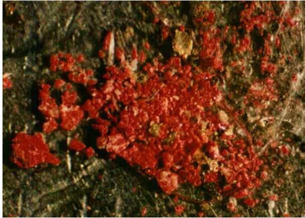
Figura 11. Macro de un estrato de color rojo oscuro con trazas de pan de oro (pequeñas partículas en amarillo-claro). No se aprecian estratos de preparación y sí mala adhesión.
