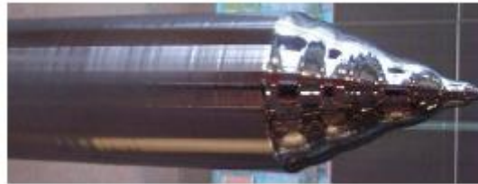
Figura 5: Lingote de silicio cristalino obtenido por el método Czochralski
