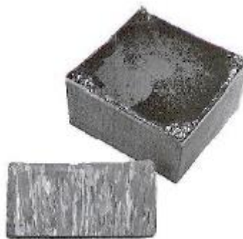
Figura 6: Lingote paralelepédico obtenido por el método HEM
