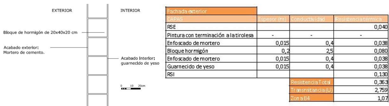
Figura 3-5. Esquema y características de la composición de la fachada exterior del edificio en su estado inicial. Fuente: Tranajo LAE 2011-2012. Plaza Collao. C. Barroso, ML. Río, E. Rodríguez, C. Rubiales. Prodesor: E. de Manuel.
