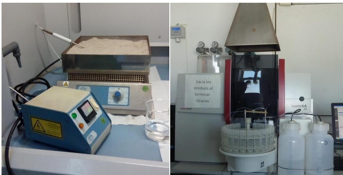
**Figura 3.2.** Baño de arena (izquierda). Espectrofotómetro de Absorción Atómica (derecha).
