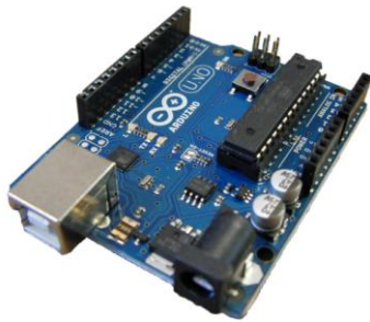
Arduino UNO con microcontrolador en formato DIP
