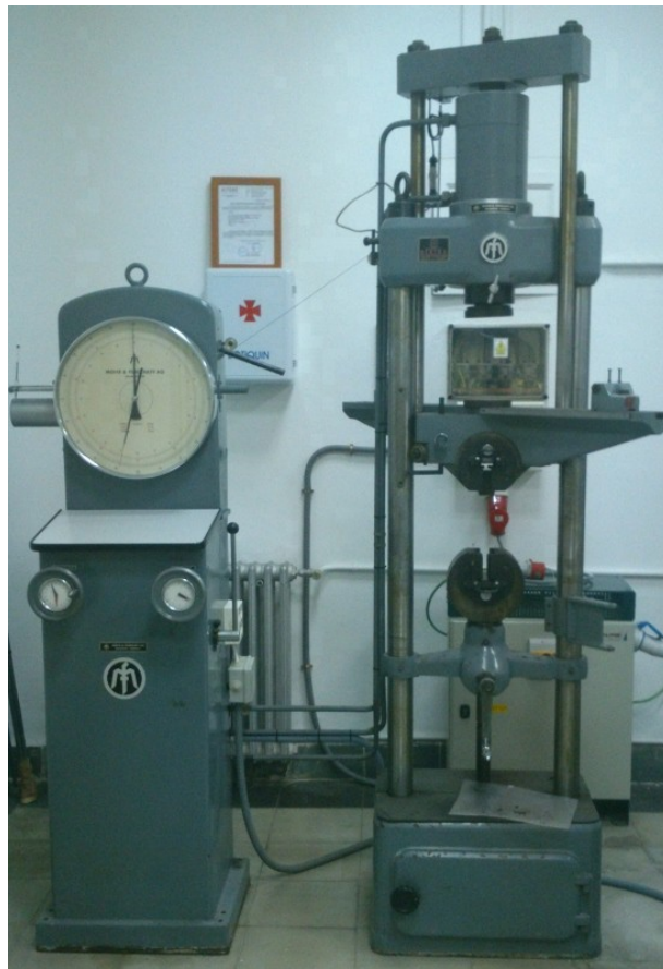
Figura:1 Máquina universal de ensayo tracción compresión. (Foto tomada en el laboratorio de Ingeniería Mecánica y de los Materiales de la Escuela Politécnica Superior)
