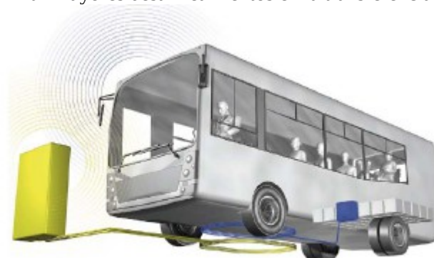
Fig. 16. Sistemas ICPT con captura de la componente normal del flujo para carga de baterías.
