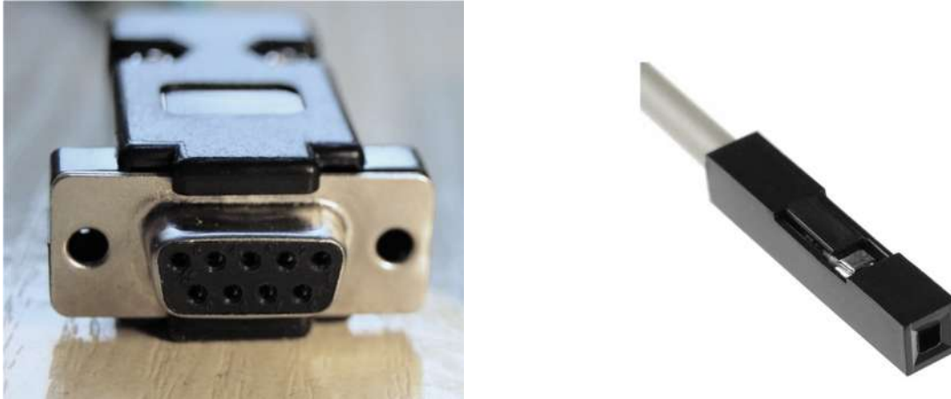
Figura 22. Detalles de los conectores DE-9F y female jumper wire
