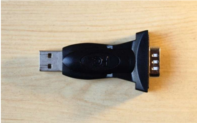
Figura 20. Adaptador USB a RS-232
