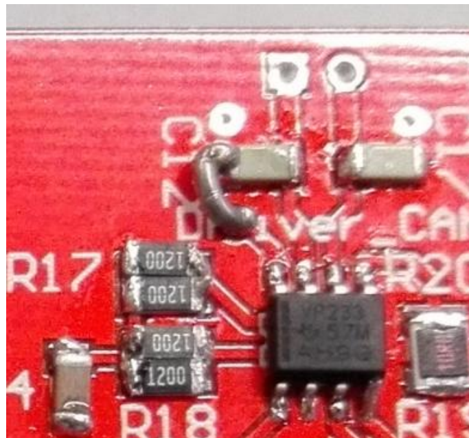
Fig. 55 Fotografía de la solución adoptada para el driver CAN de la placa de Tensión
