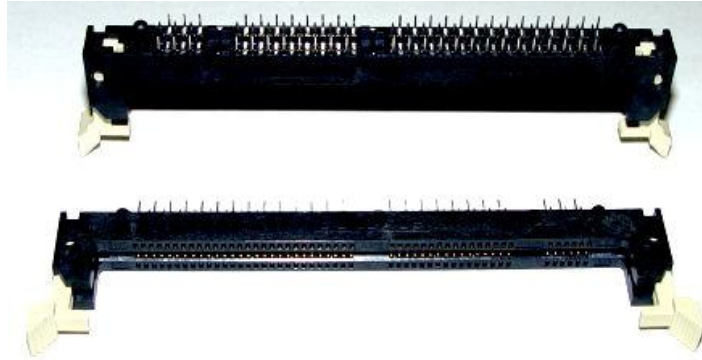
Fig. 32 Fotografía del zócalo DIMM100; (arriba) pines de conexionado de la parte inferior;(abajo) vista superior del zócalo
