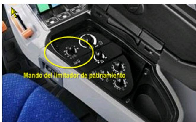
**Figura 5.- Consola de control del elevador dotada de limitador de patinamiento.**
