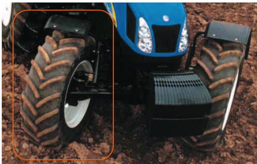
**Figura 1.- Detalle de guardabarros dinámicos con ángulo de giro inferior a la rueda para no limitar el ángulo de giro**
