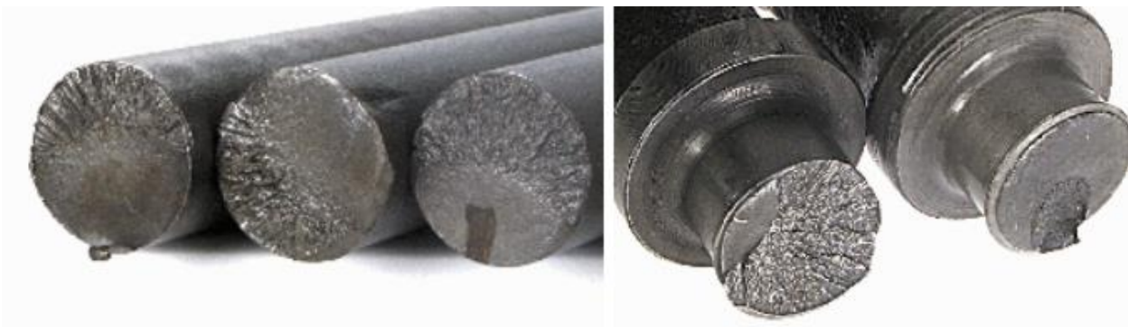
Ilustración 11 – Rotura de Ejes por Fatiga
