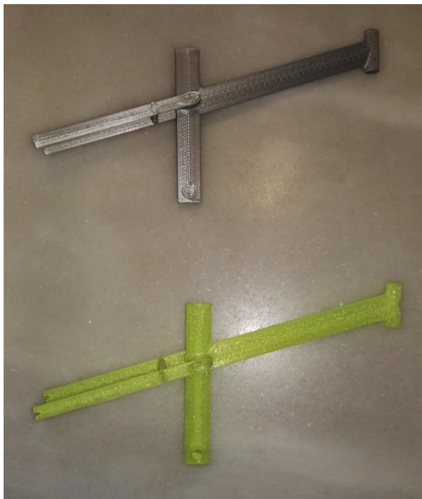
Ilustración 26 – Modelos del cuadro impresas 3D en FDM
