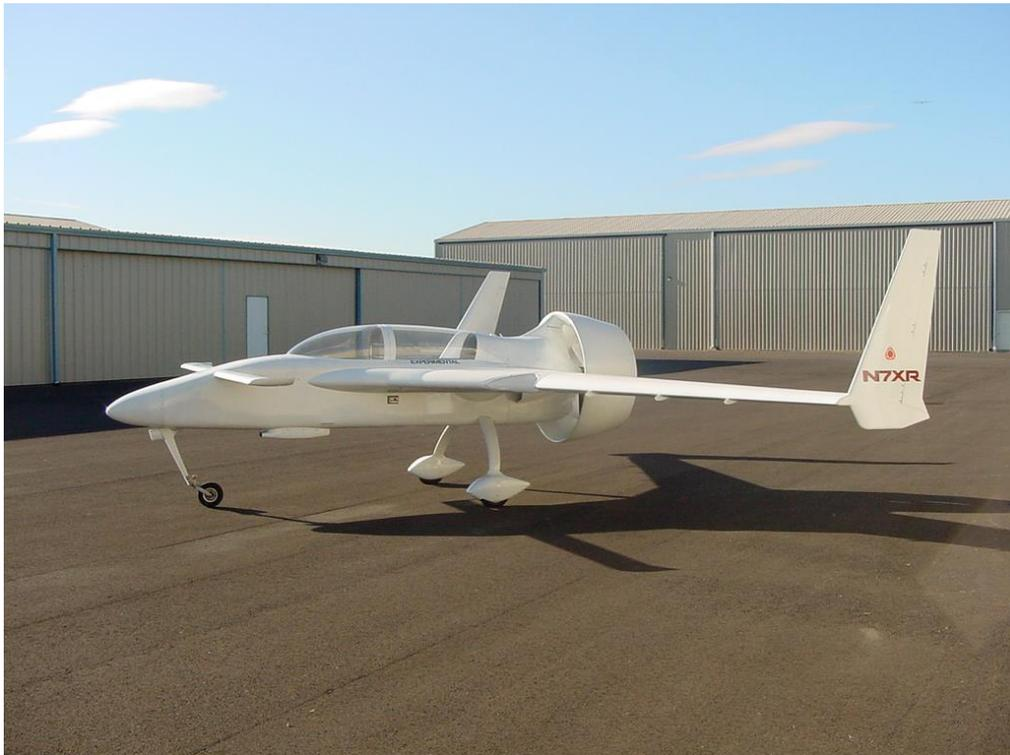
Figura 2.5: Ejemplo de avión (Mick Duckt N7XR) con ducted fan en configuración BLI
