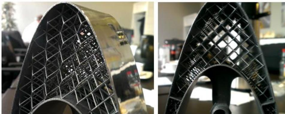
Figura 2.3: Fabricación rápida de un borde de ataque con estructura interna en forma de celosía
