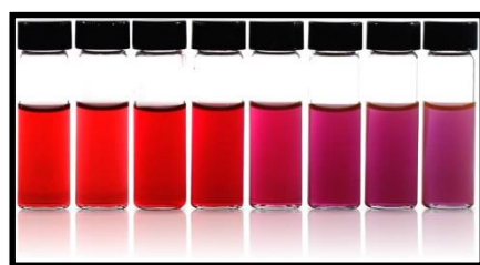
Figura 5. Nanoesferas de oro mostrando diferentes colores según el tamaño de partícula ( http://nanocomposix.eu ).
