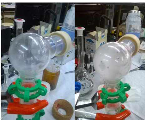
Figura 17. Fotografía del dispositivo Twin Impinger donde se aprecia cómo se va colmatando la pieza que simula la vía oro faríngea a medida que se aumenta el número de pulverizaciones (imagen de la derecha).
