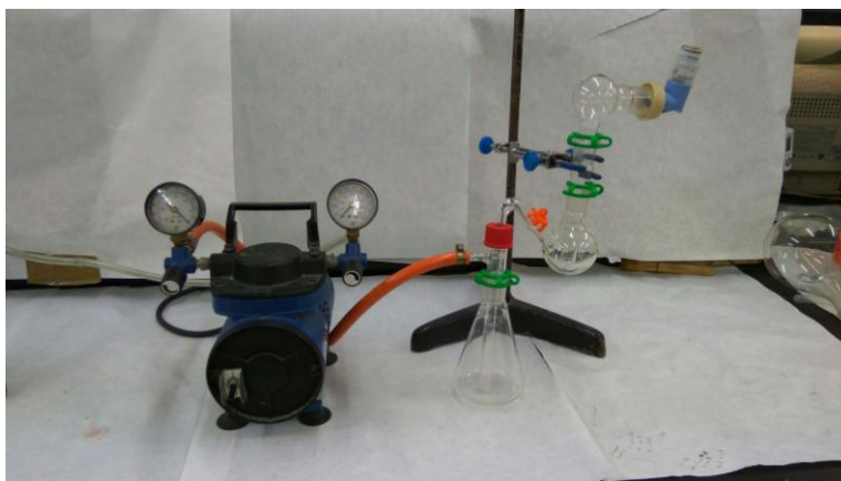
Figura 9. Estructura y componentes del Twin Impinger .
