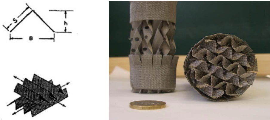
Figura 3.4: Esquema de la disposición y tamaños de un relleno estructura (der.) e imagen del relleno usado en el laboratorio Sulzer BX (izq.). Fuente: Diseño y puesta en marcha de una torre de abatimiento de tars (PFC) , Juan Estévez Cruz, figura 4.13, pag 51.
