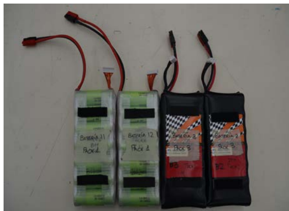
Figura 0-40. Packs de baterías Li-Fe
