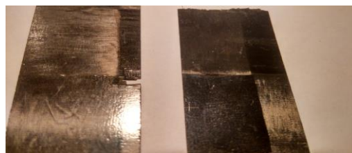
Figura 5-21. Defectos en la superficie de las probetas de tracción tras los ensayos
