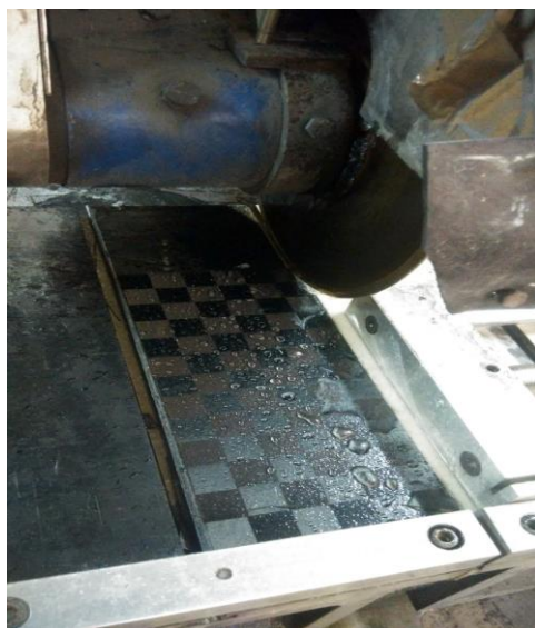
Figura 3-27. Proceso de resanar los bordes de un laminado
