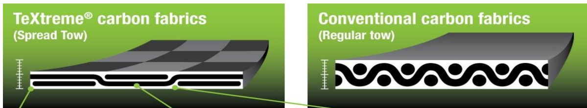
Figura 3-3. Comparación entre el tejido ultradelgado y el convencional
