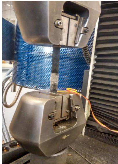
Figura 5-39. Ensayo de probeta a cortadura en INSTRON 4483
