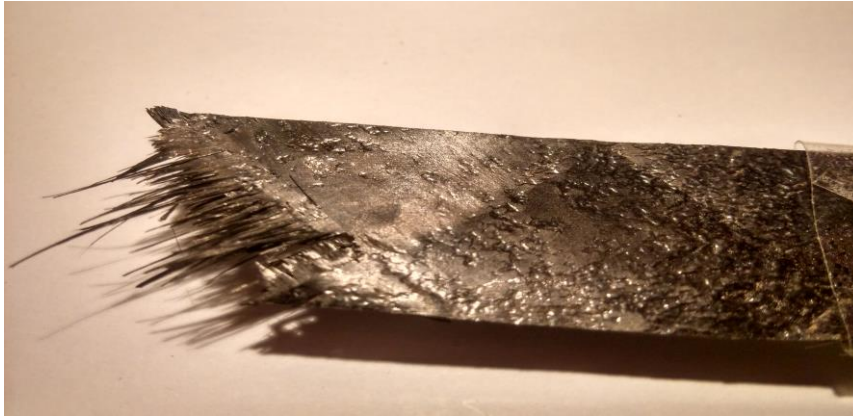
Figura 5-51. Detalle de la rotura en las probetas de cortadura intralaminar.
