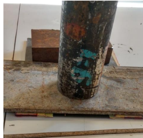
Figura 3-40. Distribución de pesos sobre los tacones
