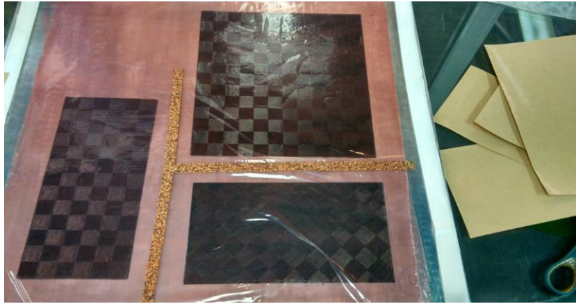
Figura 3-20. Distribución de los laminados en la bolsa de vacío
