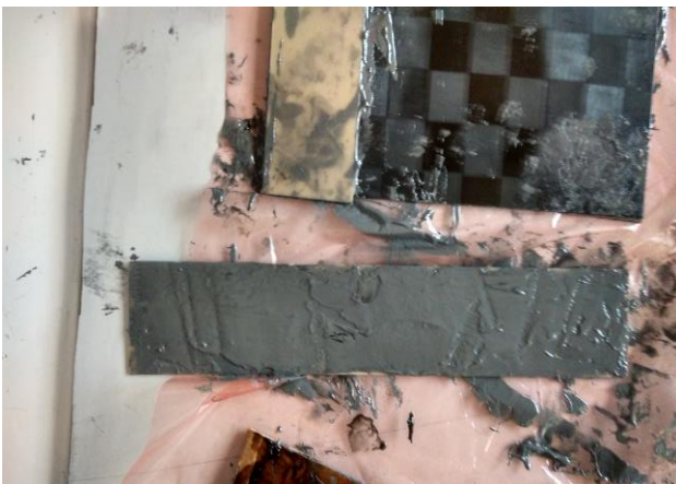
Figura 3-37. Tacón con adhesivo aeronáutico
