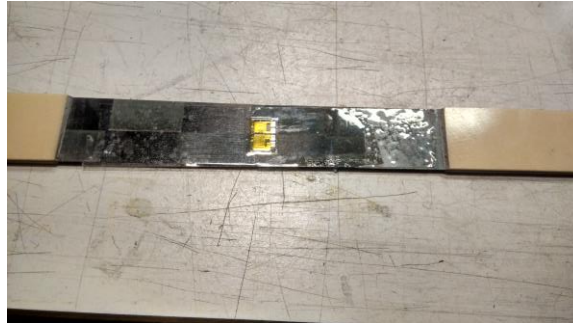
Figura 3-51. Centrado de la banda extensométrica con la ayuda de cinta adhesiva
