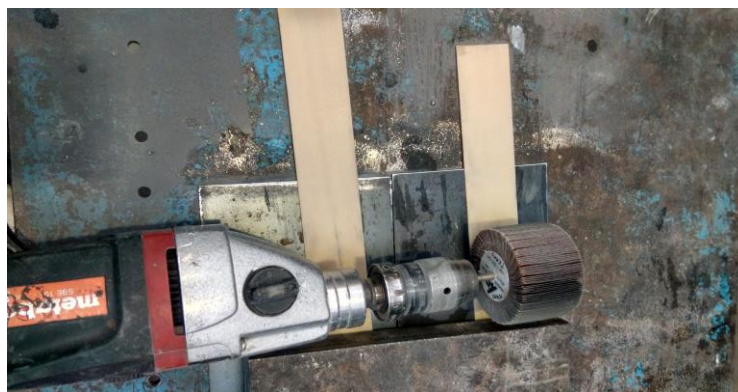
Figura 3-32. Proceso de lijado de los tacones de fibra de vidrio
