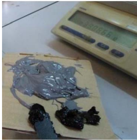
Figura 3-36. Mezcla de adhesivo y catalizador
