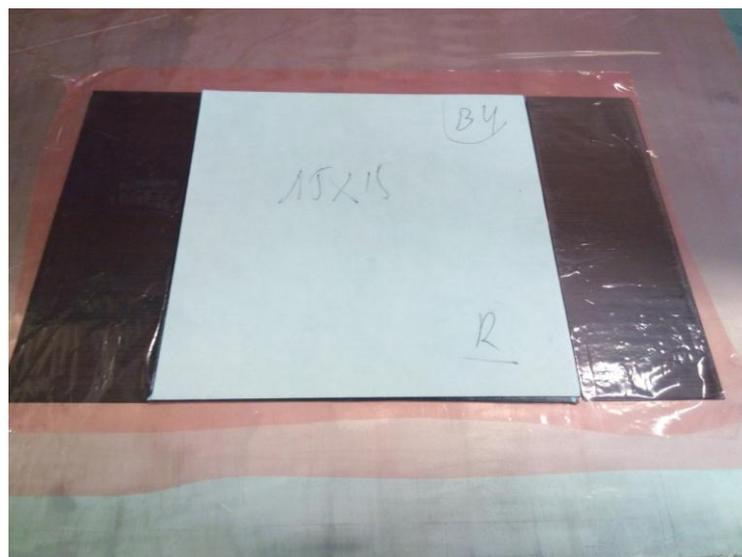
Figura 2-16. Montaje de configuración B4 sobre la plancha de la bolsa de vacío
