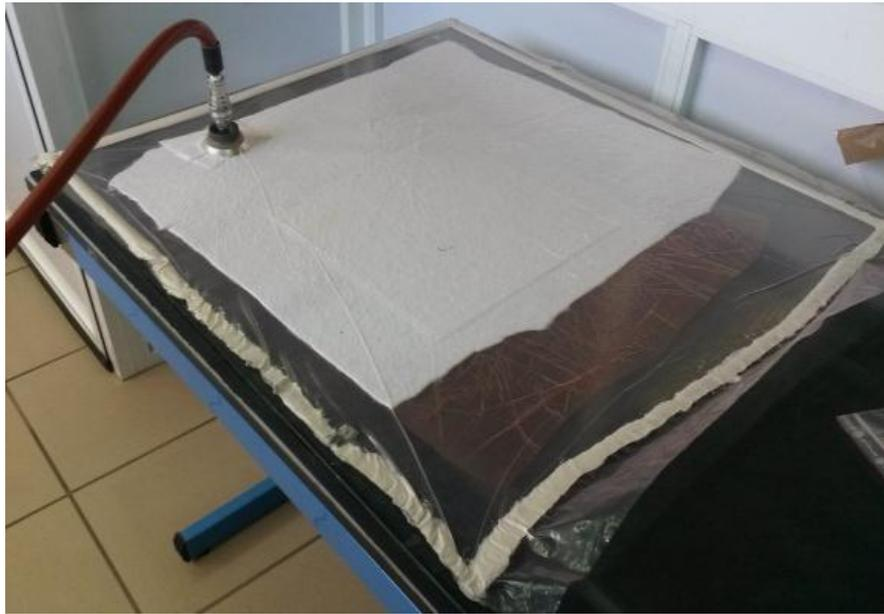
Figura 2-14. Aplicación de vacío para compactación
