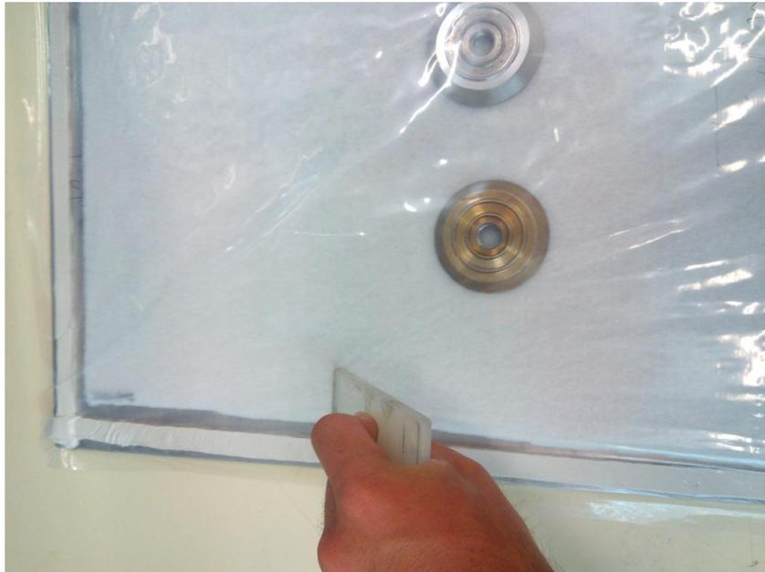
Figura 2-18. Cierre final de la bolsa de vacío
