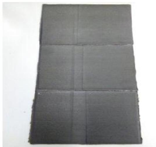
Figura 2-22. Paneles configuración C extraídos de Autoclave
