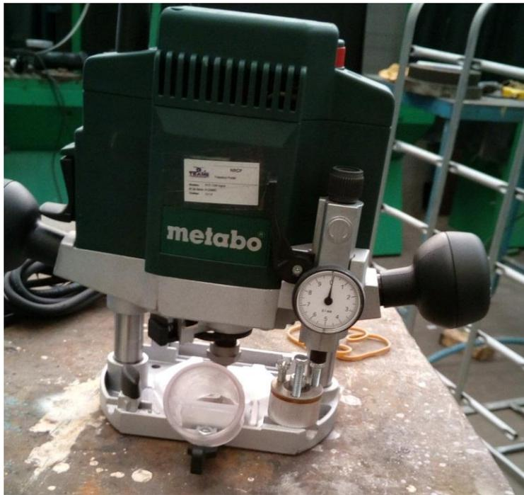
Figura 2-24. Fresadora empleada para resanado
