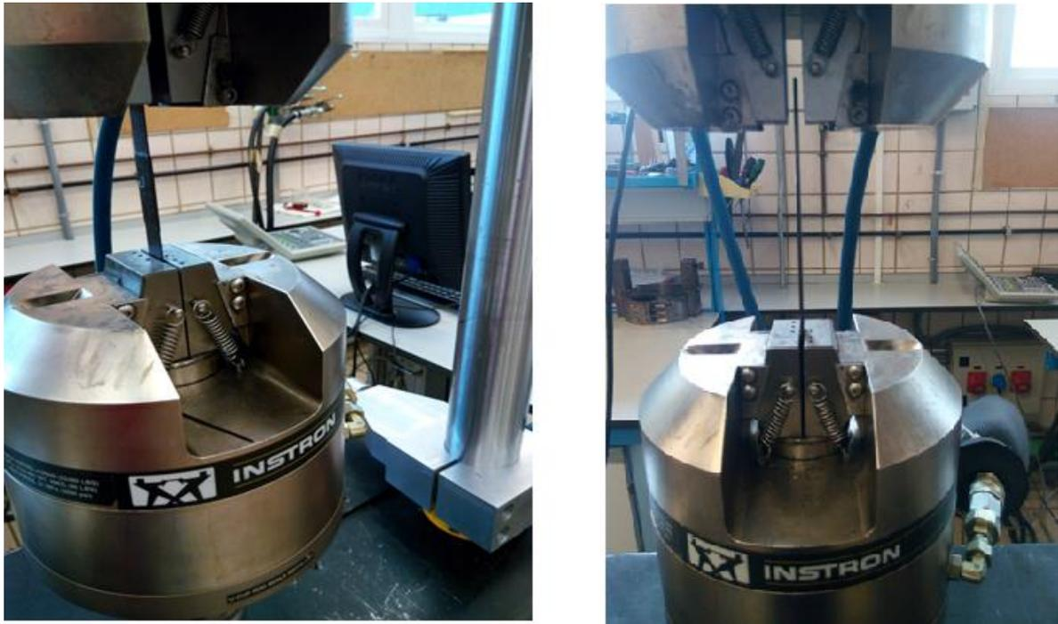
Figura 3-2. Posicionamiento de la Probeta en la máquina INSTRON
