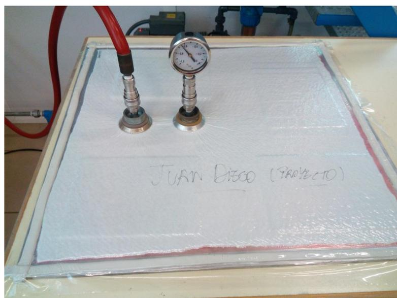
Figura 2-19. Bolsa de vacío finalizada
