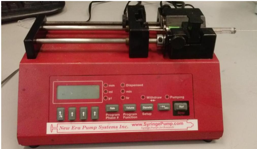
Figura 4-19. Sistema de aspiración. Prototipo C. Bomba de jeringa
