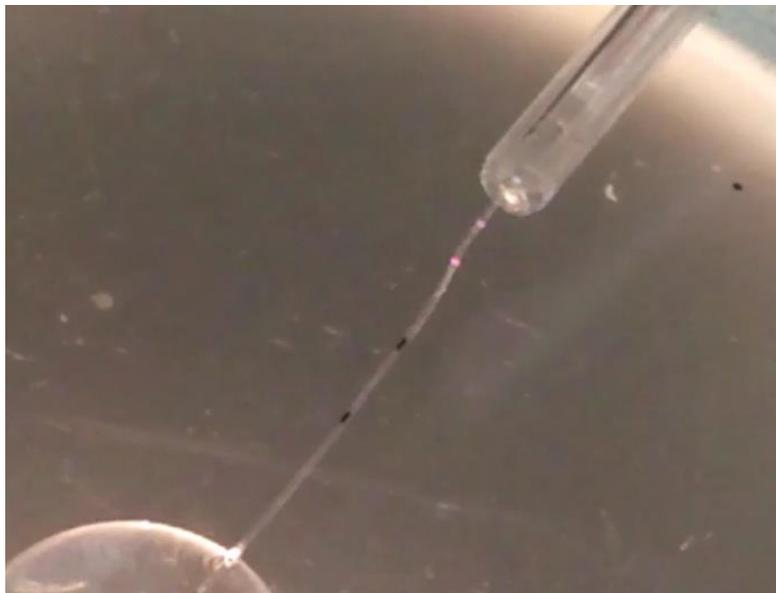
Figura 4-3. Parte visible del capilar del SafeSpeed.
