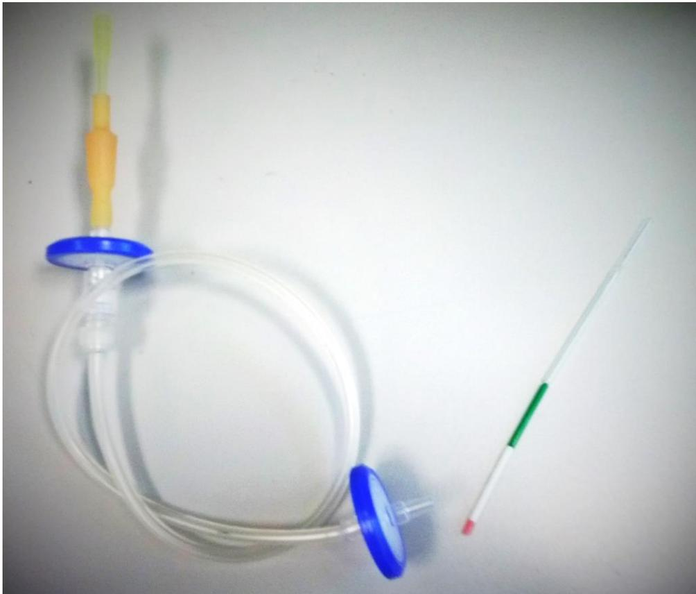
Figura 4-1. Sistema de aspiración por boca.
