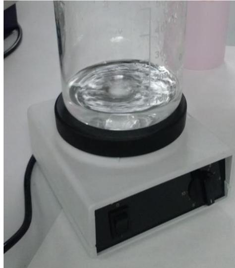
Figura 4-10. Agitador magnético.
