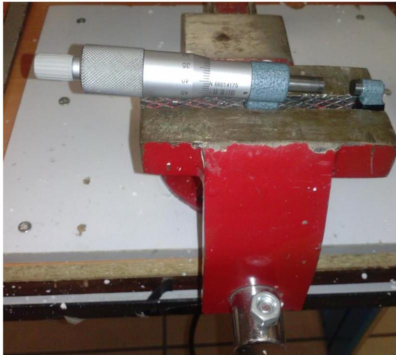
Figura 4-15. Fijación del tornillo micrométrico, previa a la realización del corte.
