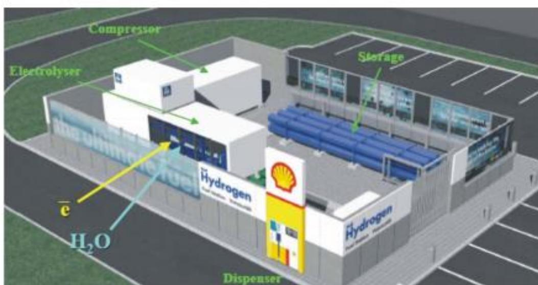
Ilustración 2-14 *Esquema de la estación de abastecimiento de combustible hidrógeno del proyecto ECTOS de Reykjavik, Islandia (Ulleberg, 2007)*
