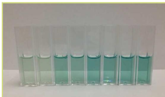
**Figura 3.** Cubetas con las disoluciones patrón a distinta concentración y el reactivo ABTS.
