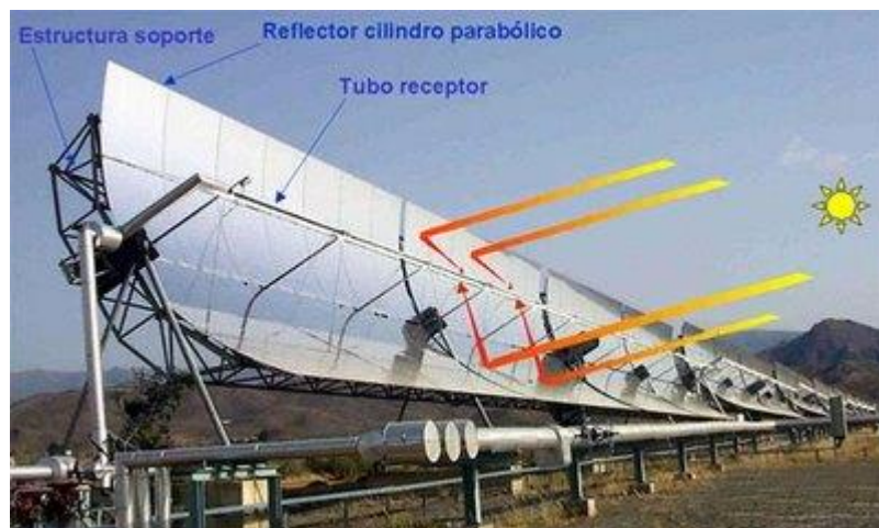
Figura 2-1 Concentración de rayos solares en tubo central de colector cilindro-parabólico (cortesía de Abengoa Solar)
