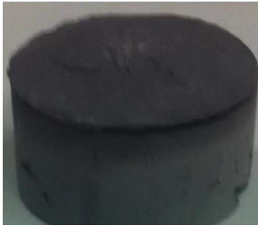
*Ilustración 52 Ensayo 12: Probeta abombada y con costra*
