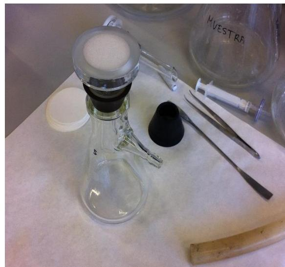
*Ilustración 28 Equipo de filtrado*
