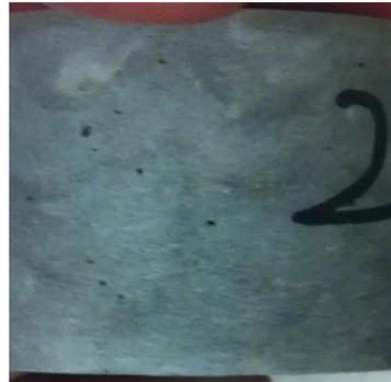
*Ilustración 47 Ensayo 2: poros*
