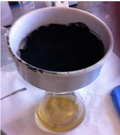
*Ilustración 27 Filtración mediante filtro Buchner (2)*
