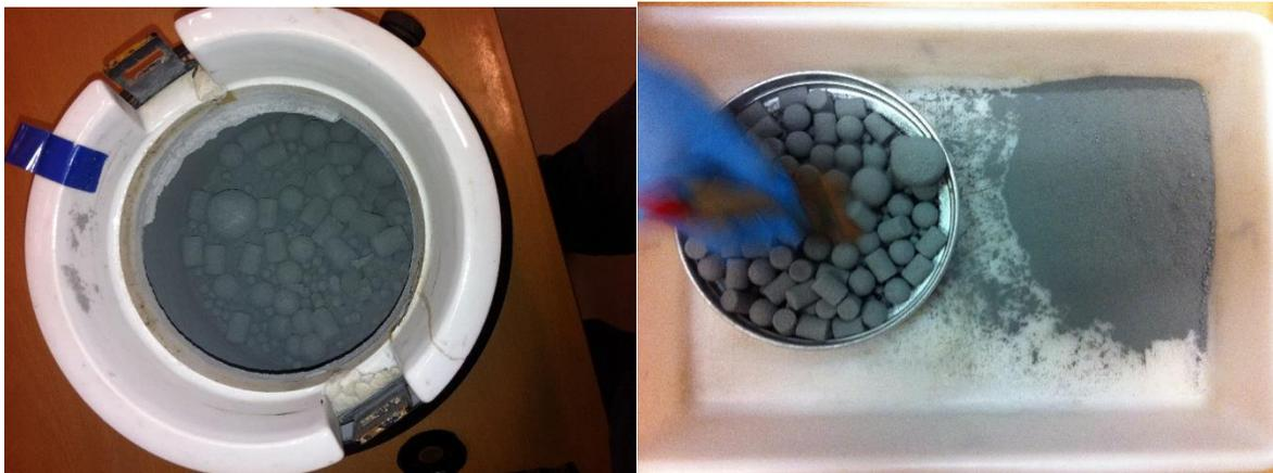
*Ilustración 11 Finalización de la molienda, limpieza del equipo*
