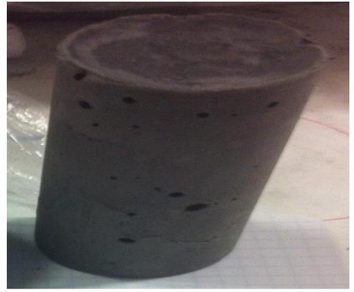
*Ilustración 51 Ensayo 7: Probeta con falta con huecos*
