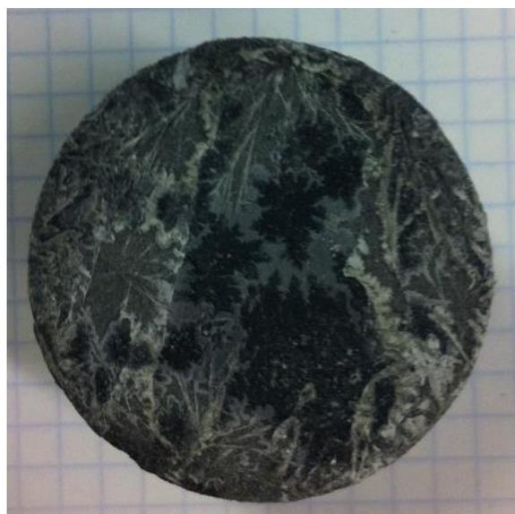
*Ilustración 49 Ensayo 4: Eflorescencias*
