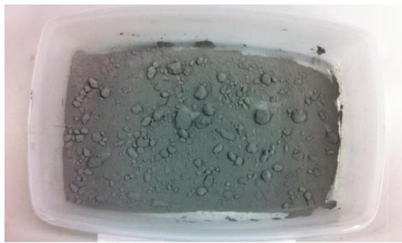
*Ilustración 12 Impregnación del Paval con NaOH*
