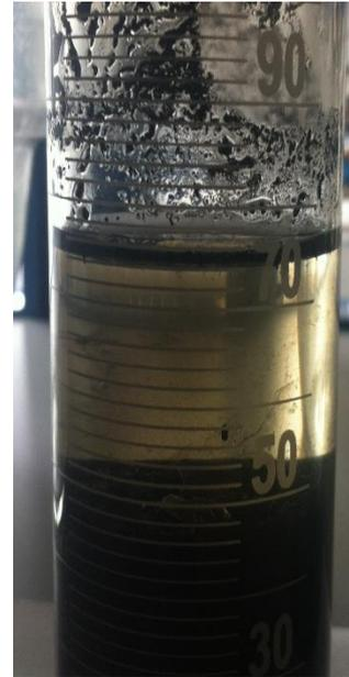
Ilustración 23 Fases en la probeta tras decantación de ceniza
