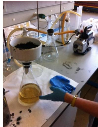
*Ilustración 26 Filtración mediante filtro Buchner (1)*
