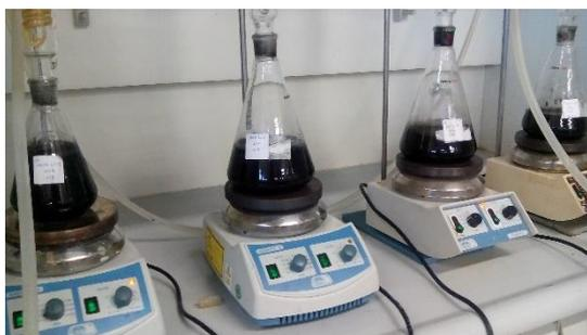
*Ilustración 19 Ataque ceniza de cascarilla de arroz*
