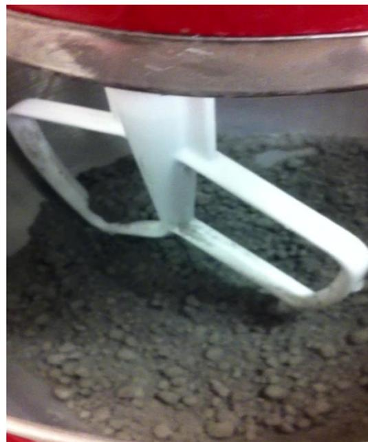
*Ilustración 30 Mezcla sólido - solución activadora en amasadora*
