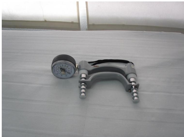
Foto 1: Dinamómetro de presión manual JAMAR®, modelo 5030J1, Illinois, USA.
