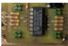
Figura 9. Fotografía de la lógica OR del circuito de adaptación
