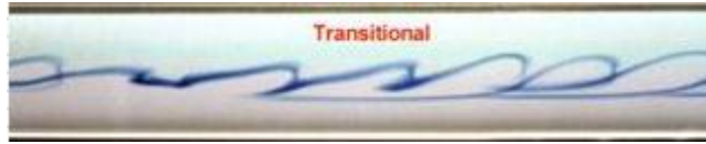
Figura 1-10 Chorro de colorante en régimen de transición
