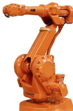
Figura 1-1. Robot manipulador de la marca ABB. Modelo IRB 2400. (6 grados de libertad)
