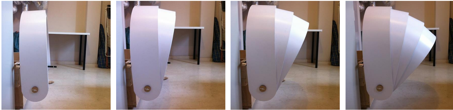
Fig. 174. Toldo de ventana. Prototipo. Diferentes posiciones en movimiento de apertura y cierre.
