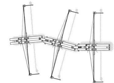
Fig. 52. "Stiquito" robot-insecto con músculos de alambre de Nitinol. Alimentado por dos pequeñas baterías y controlado por un microprocesador
