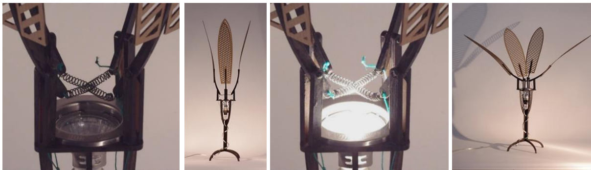
Fig. 67. “Nitinol Kinetic Lamp”. Dos muelles de Nitinol se activan con el calor generado por la lámpara
