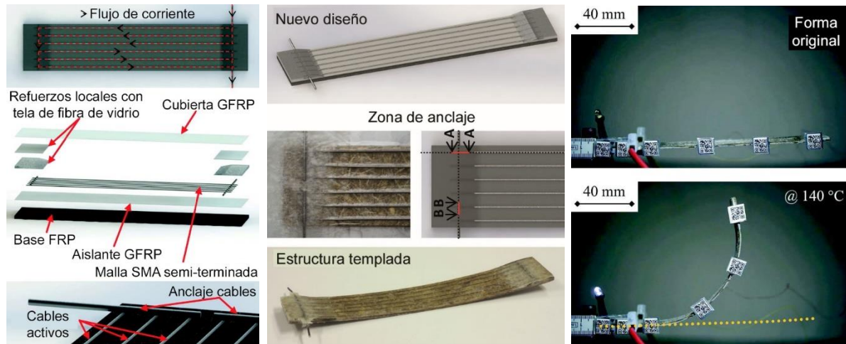
Fig. 55. Polímeros con fibra de vidrio y cables de NiTi embebidos y activados eléctricamente.
