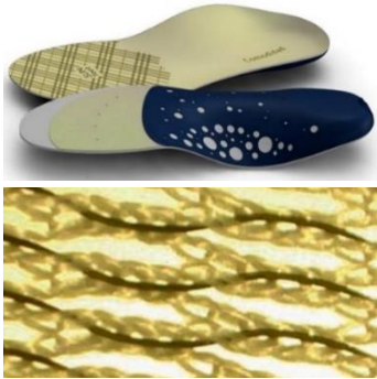
Fig. 50. Hilos de NiTi intercalados en la fibra textil
