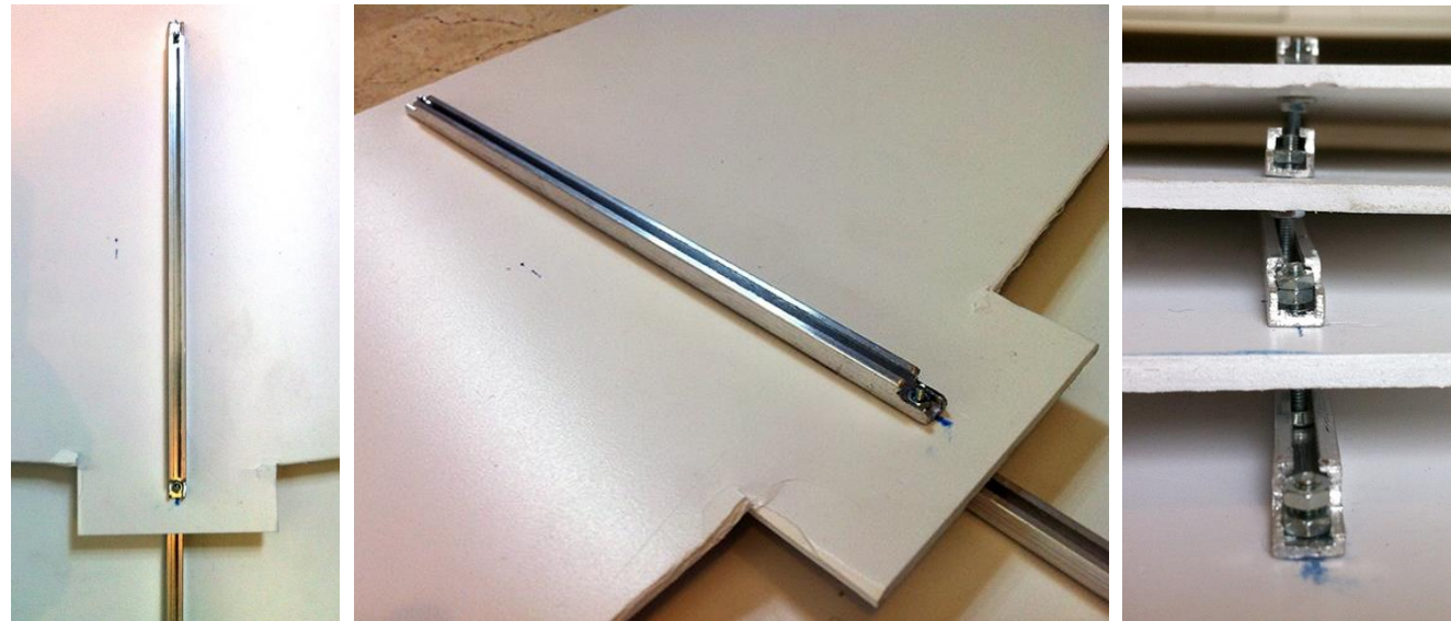
Fig. 170. Detalle de perfiles huecos de aluminio con micro tornillos sirviendo de fijación y de guía para el movimiento
