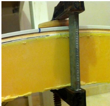
Fig. 176. Molde de resina de poliuretano para fabricación de lamas de madera de balsa curvadas. Sargentos comprimiendo las lamas con adhesivo
