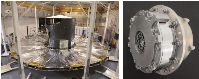
Fig. 40. Dispositivo actuador basado en NiTi (derecha) en misión GAIA (izquierda)
