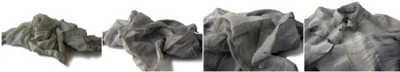
Fig. 51. El textil arrugado, recupera su forma inicial, al aplicarle calor
