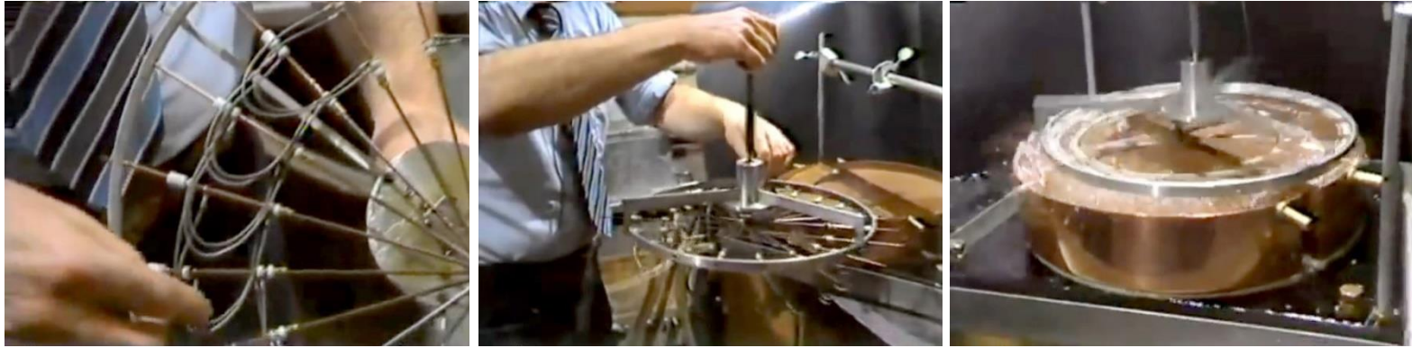
Fig. 90. Motor de calor con cables de Nitinol. R. Banks (1973)
