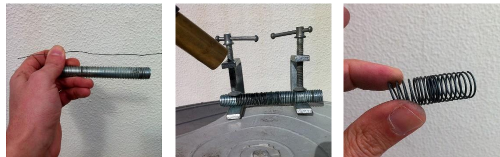
Fig. 121. Programación Nitinol con chapa de acero microperforada y soplete de propano. Fijación en forma de alfa mediante tornillos y tuercas.
