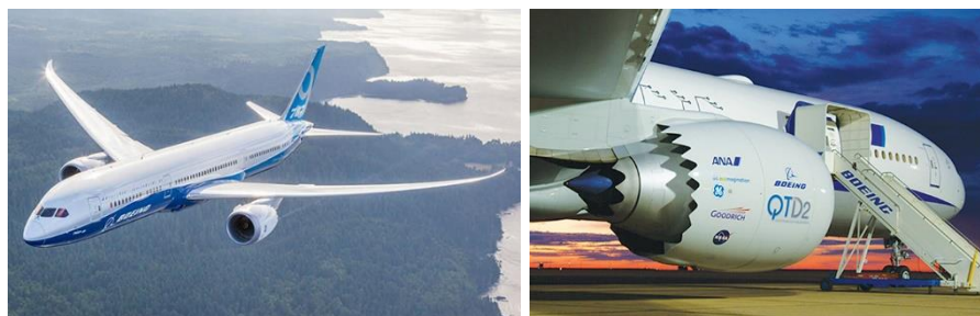
Fig. 37. Boeing 747 Dreamliner, con chevron modificado con SMA para reducción de ruido. Funcionamiento autónomo y dependiente de la temperatura
