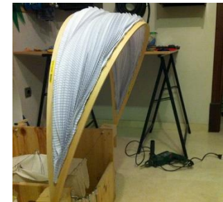
Fig. 177. Toldo de ventana con cobertura de papel plegado. Posiciones cerrado y abierto
