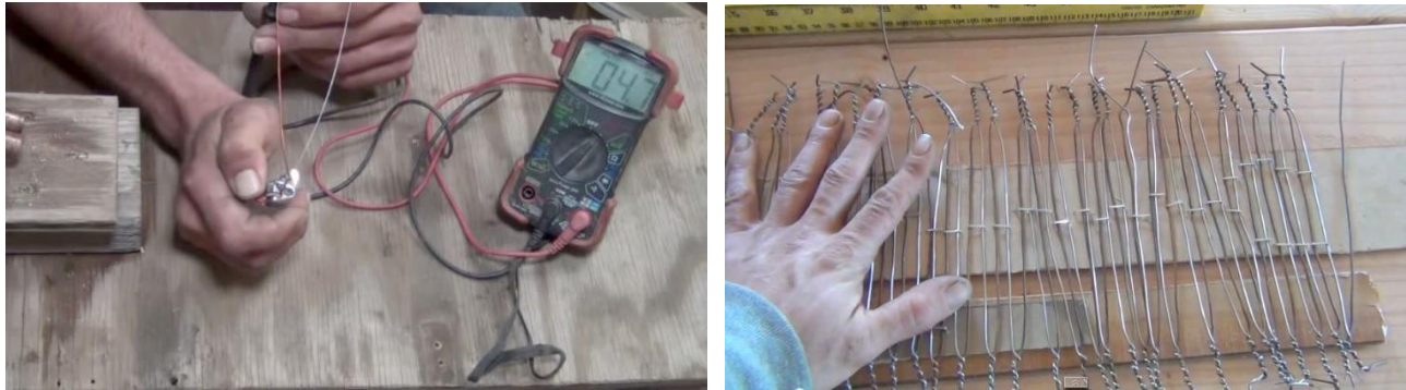
Fig. 28. Efecto termoeléctrico al calentar la unión de dos barras conductoras, una de Nitinol y la otra de Cobre (izquierda). Conexión en serie de múltiples cables de Cobre y Aluminio (derecha)
