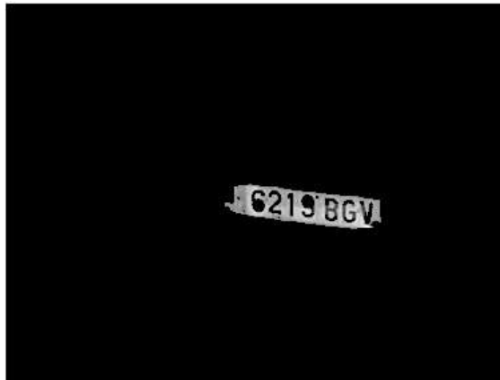
Figura 10. Mediante técnicas apropiadas, se delimita la región que contiene la matrícula del vehículo.
