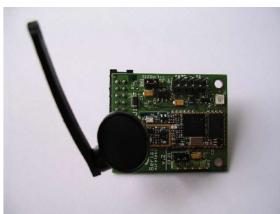
Figura 8. Sistema electrónico para comunicaciones inalámbricas: módulo Bluetooth.
