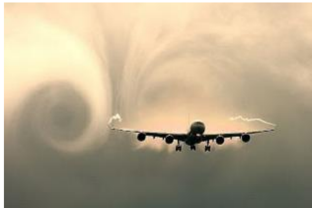
Ilustración 8. Efecto de un Winglet en vuelo.
