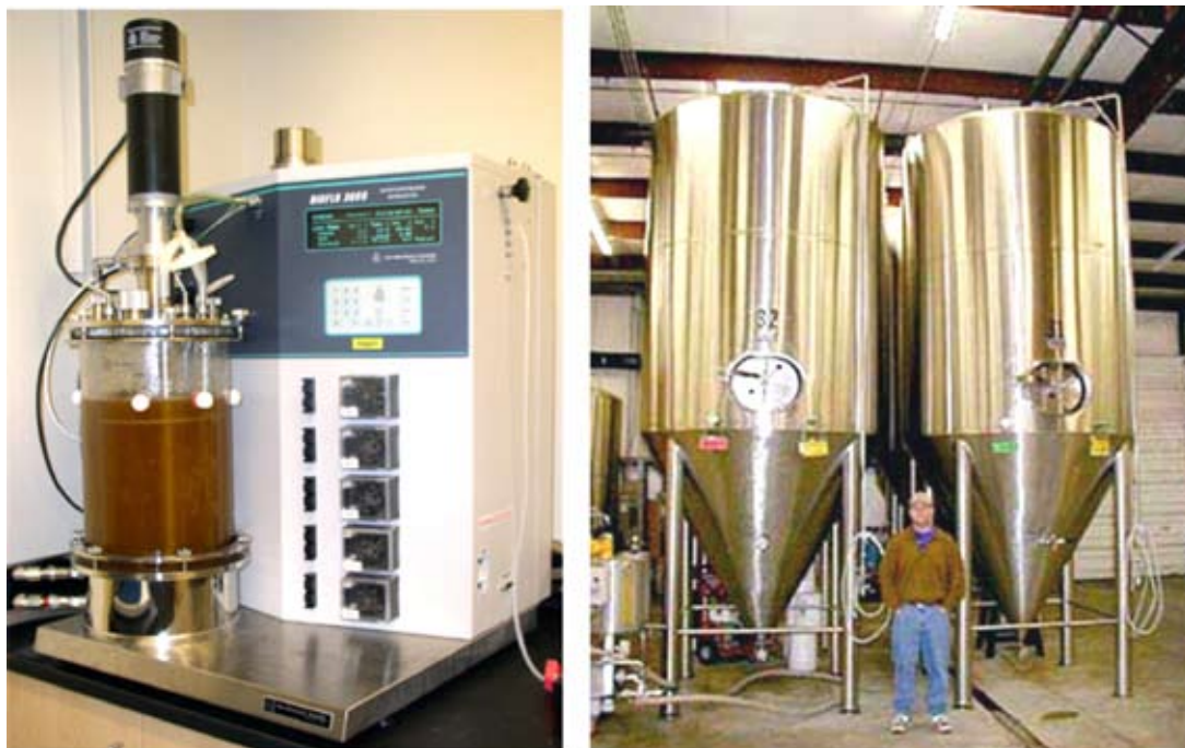
Figura 5: Equipos de fermentación nivel industrial y de plantas pilotos.
