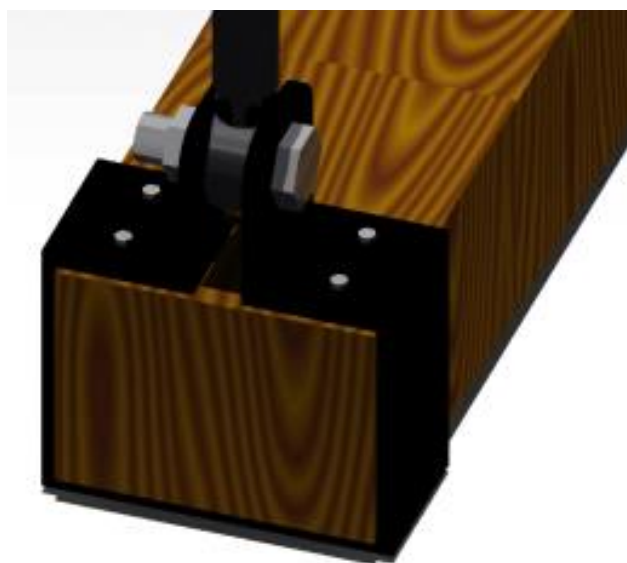
Figura 83 Elemento de unión entre el puente y la llave de alivio.
