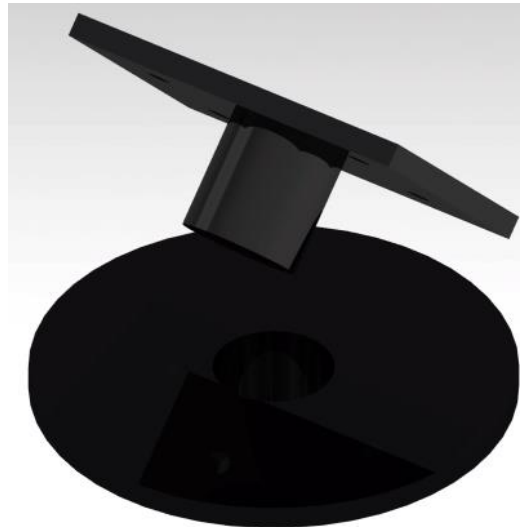
Figura 106 Sistema pivote-casquillo, giro inferior de la cabria.
