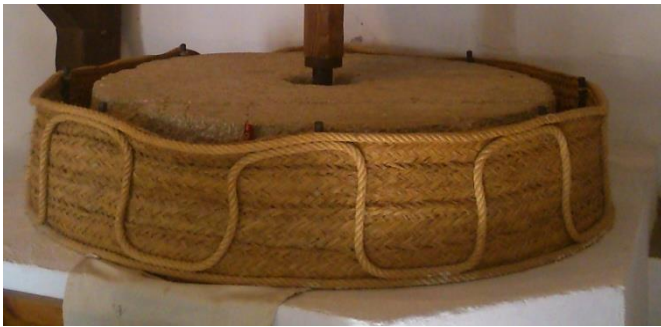
Figura 24 Guardapolvo de una de las paradas del molino de Inca.
