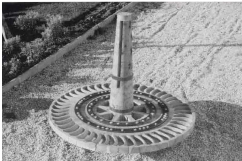
Figura 59 Rodezno ya terminado listo para su colocación. Foto tomada de (8).
