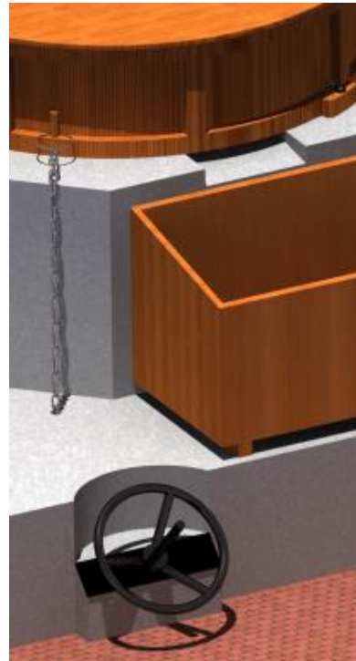
Figura 80 Cadena de la paraera y volante de la llave de la espada.
