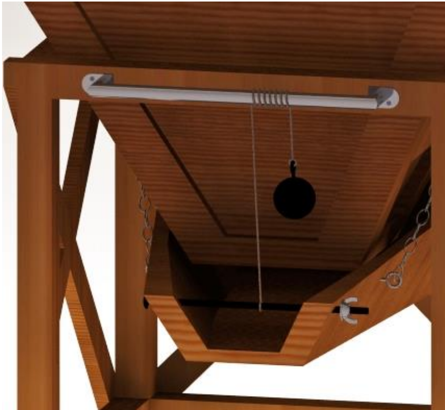
Figura 102 Mecanismo para la regulación de la inclinación de la bandeja.
