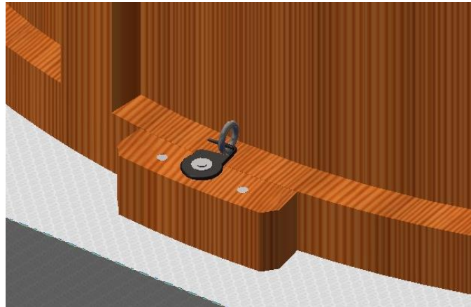
Figura 96 Sujeción del guardapolvo al alfanje.
