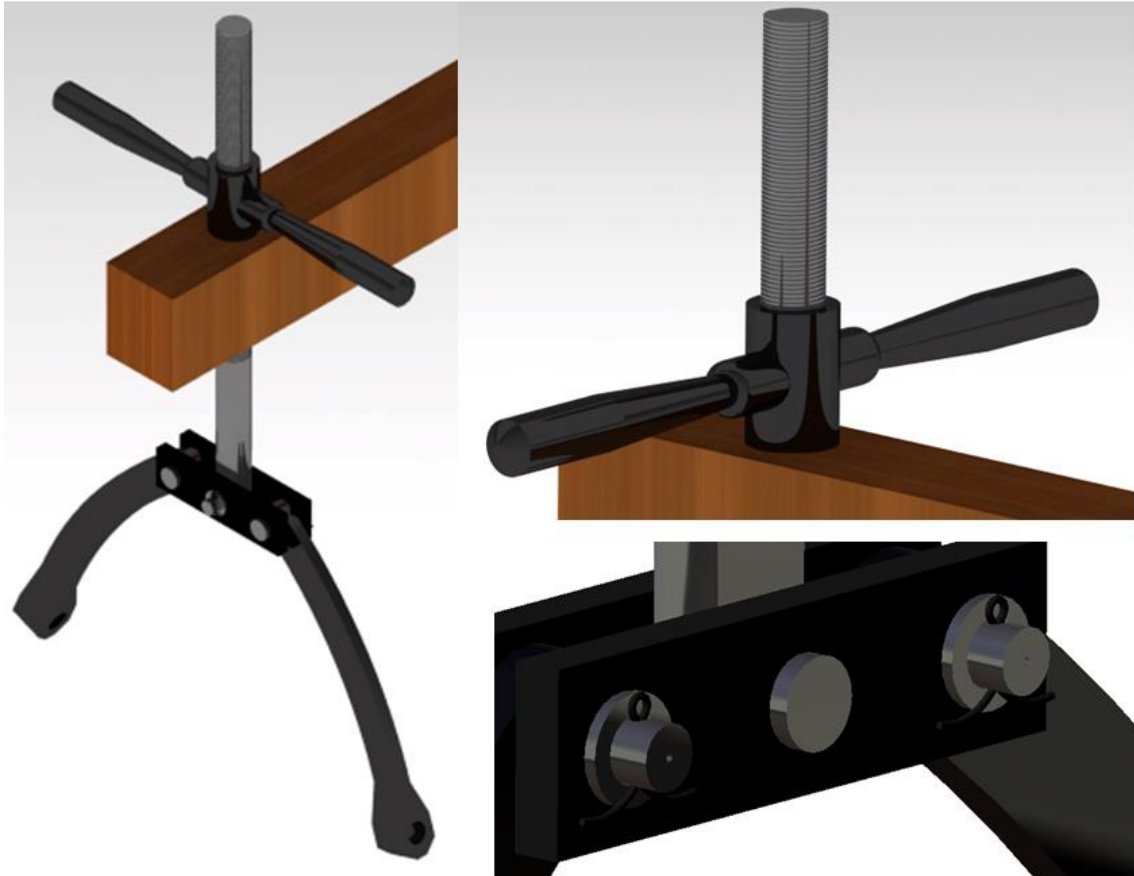
Figura 110 Abrazaderas, eje y palanca de la cabria.
