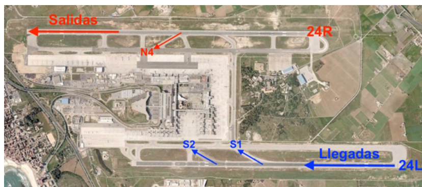
Figura 2-2. Configuración Oeste con calles de salida rápida disponibles.
