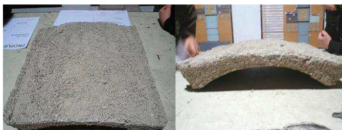
Fig. 8 “Bovedillas de prueba con molde existente Prueba 1 y 2”
