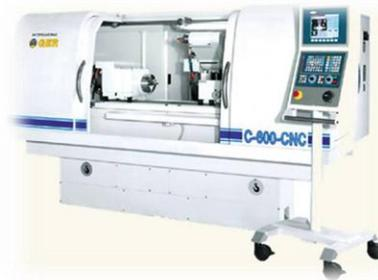
Figura 4. 7. Ejemplo de rectificadora de control numérico.
