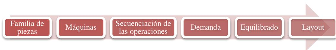
Figura 2. 9. Pasos en el diseño de una célula. Fuente: Elaboración propia.
