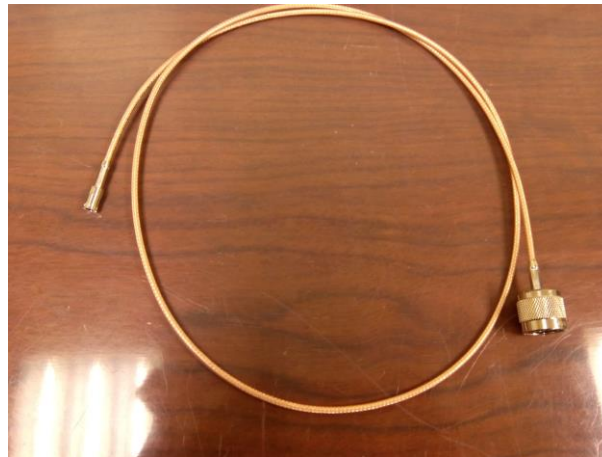
Figura 20: Cable de conexión de la sonda mediana al analizador de espectros.
