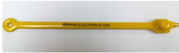
Figura 19: Sonda campo próximo para medición del campo magnético
