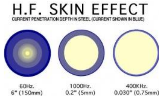
Figura 67: Ejemplos para ilustrar el efecto skin en un conductor cilíndrico a diferentes frecuencias; conforme aumenta la frecuencia disminuye la sección en forma de corona (sección azul)
