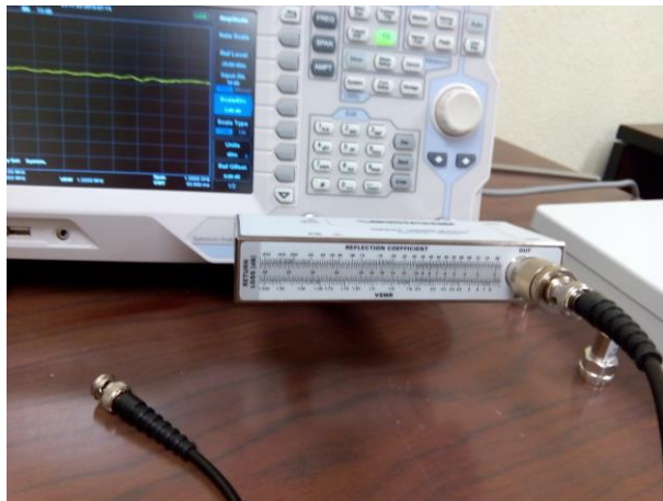
Figura 18: Reflectómetro conectado a analizador de espectros
