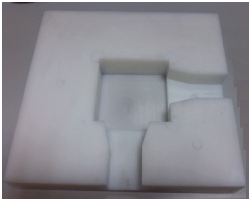
FIGURA 2.5: Maniquí plano, tiene un hueco para albergar la caja del detector y la salida de los cables
