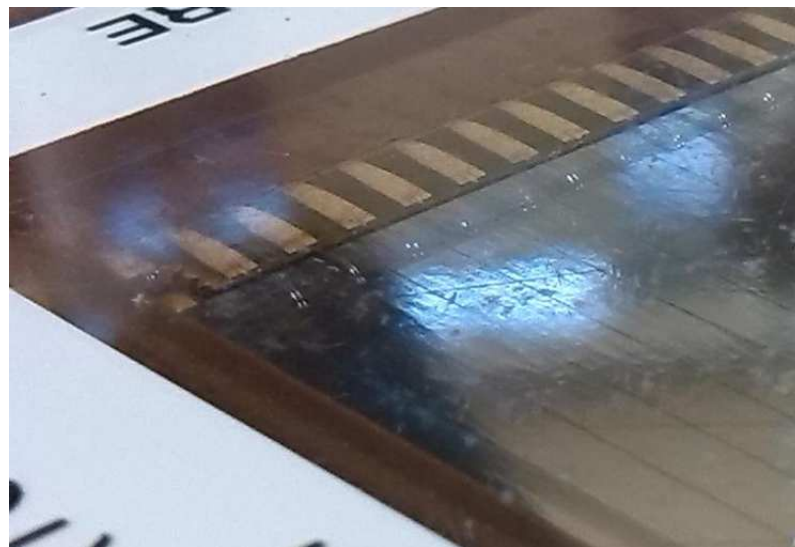
FIGURA 2.2: Detalle de los contactos entre cada una de las tiras del detector y las pistas de salida. El anillo de guarda, que también actúa como cátodo puede observarse en esta imagen.
