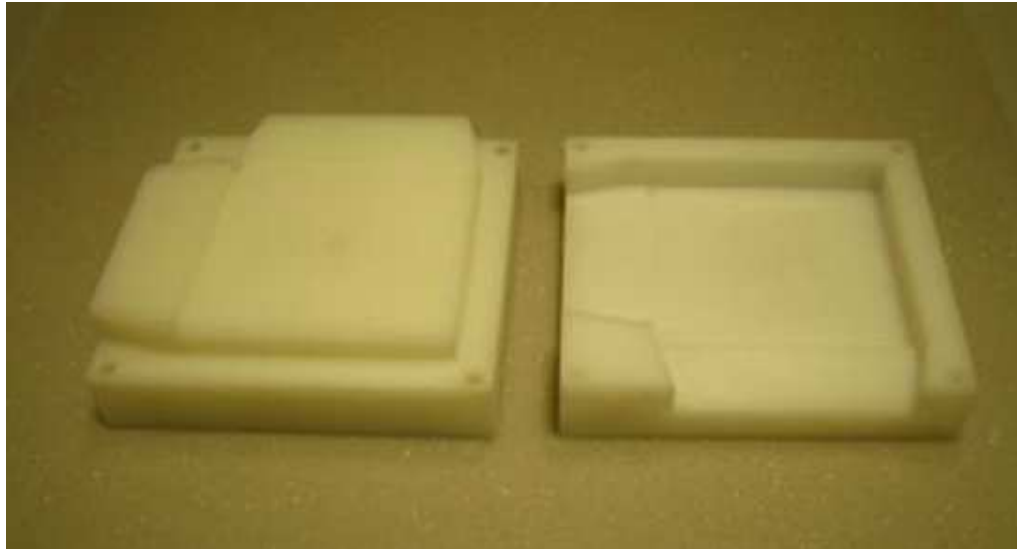
FIGURA 2.4: Caja para almacenar el detector minimizando las capas de aire. A la izquierda vemos la tapa de la caja. A la derecha vemos la caja donde se instala el detector
