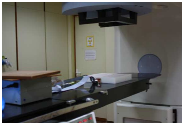
FIGURA 4.1: Sistema de adquisición de datos y maniquí plano con el detector alojado en la camilla del acelerador, dispuesto para las medidas.
