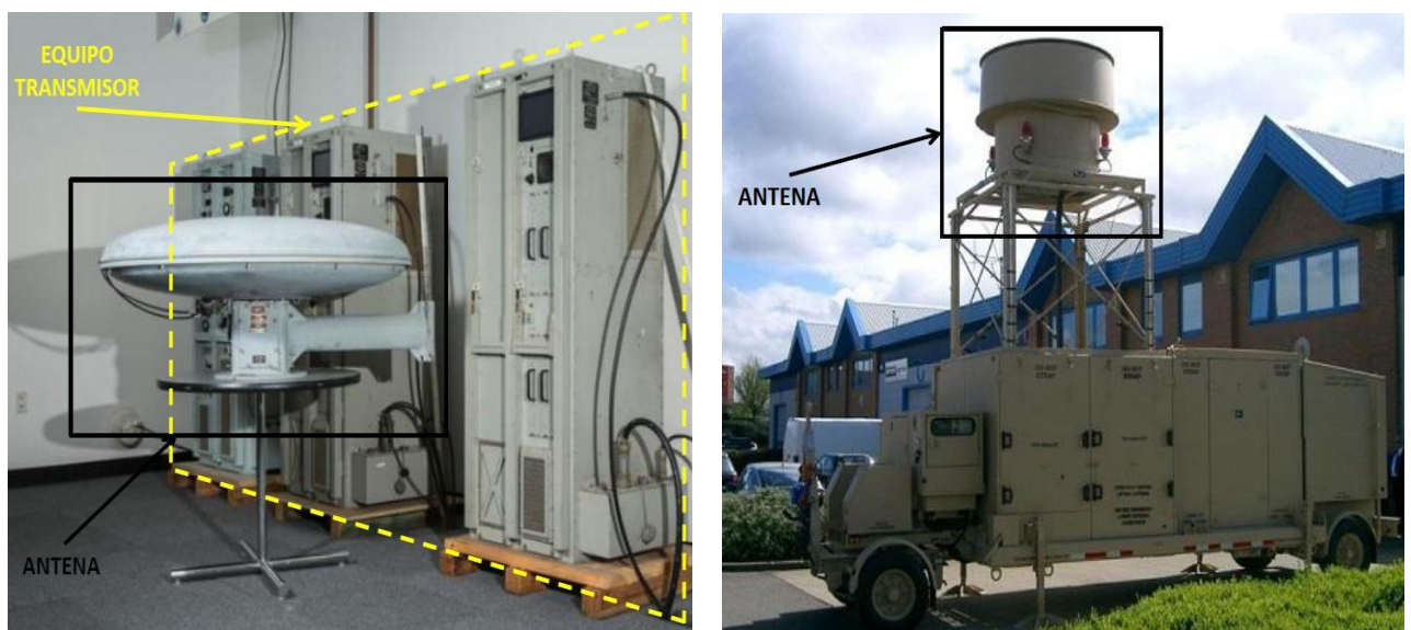
Figura 2.24: Antena TACAN y equipo de transmisión AN/URN-32 empleado por la Navy en la actualidad (izquierda), y estación TACAN portátil del ejército polaco (derecha). Imágenes obtenidas de [16] y [17] respectivamente.
