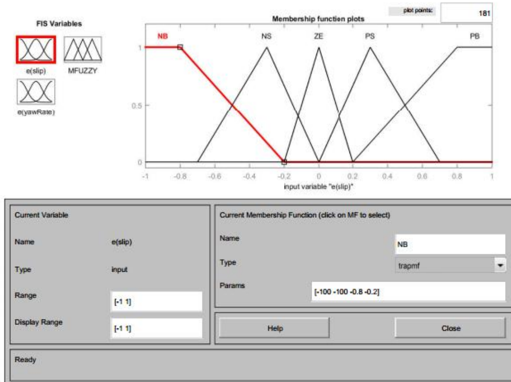
Figura 7-15 Funciones de pertenencia del error de deslizamiento
