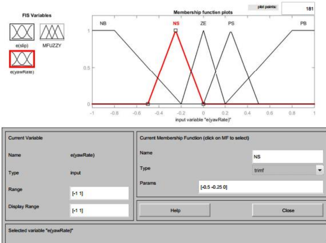
Figura 7-16 Funciones de pertenencia del error de yaw rate
