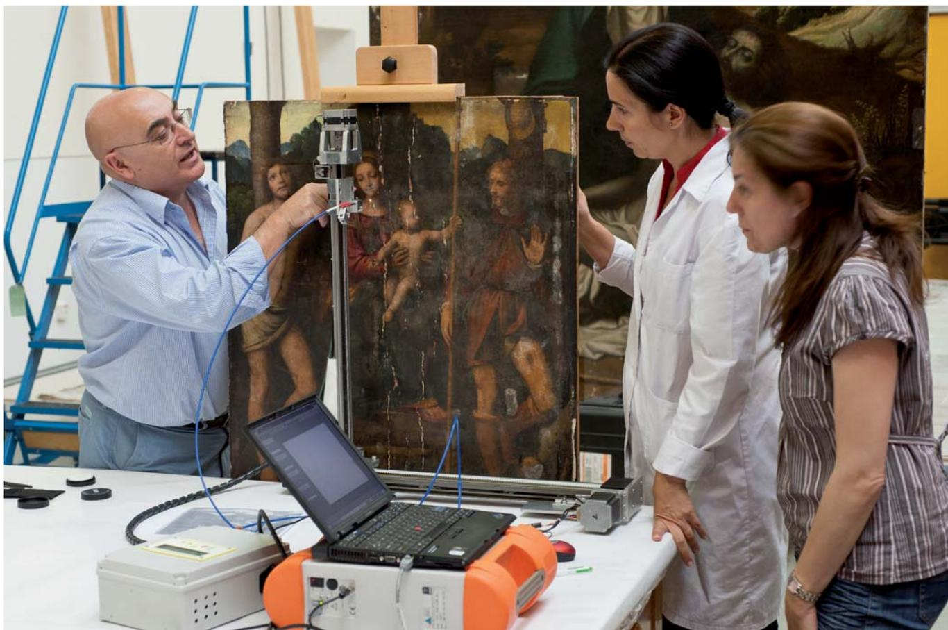
Equipo de espectrometría de reflectancia difusa acoplado a un sistema automatizado de adquisición de espectros
