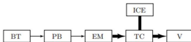
Figura 5 Flujo de potencia en híbridos en paralelo para u=1 .
