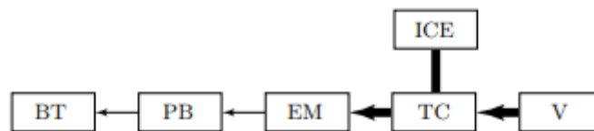
Figura 8 Flujo de potencia en híbridos en paralelo para u = 1 .
