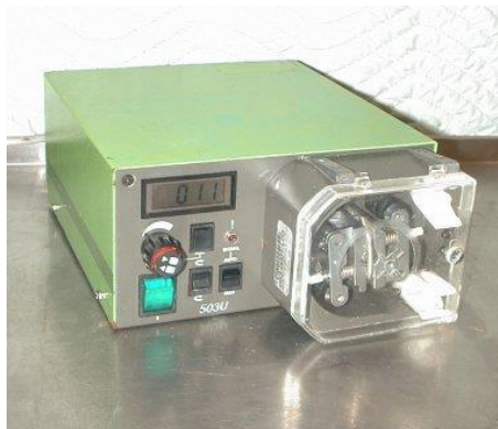
Figura 2.13. Bomba de agua Waston Marlow 503U (P02)
