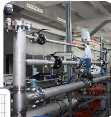
Seguimiento del ensayo con una aplicación específica con Labview 2013 para el control de caudal, pesada y tiempo.
