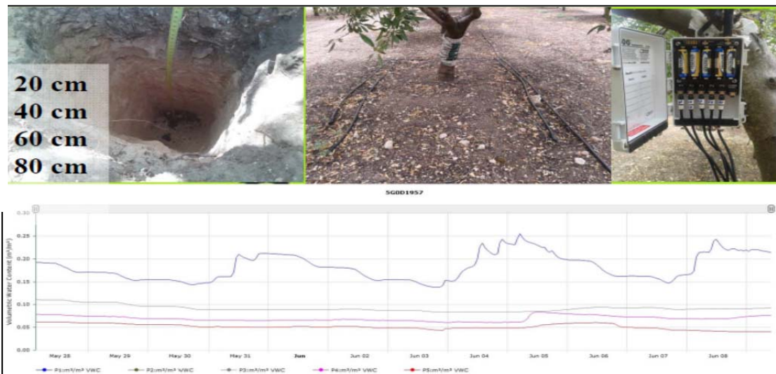
Figura 2. Imágenes del funcionamiento del sistema de seguimiento de humedad en los distintos perfiles del suelo. Arriba a la izquierda, detalle de la instalación de los sensores en el suelo. Arriba en el centro y a la derecha, detalle de la instalación del data-logger sobre el tronco y el sistema de transmisión de datos. Y abajo el resultado, en gráficas de la evolución de la humedad en las distintas profundidades.
